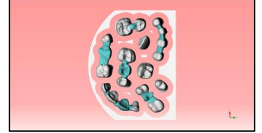
GO2dental 自动定位牙齿即节约了时间又最大限度的节约了原材料
